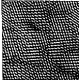
Obrázek 46: Falešná atomární struktura, vzniklá nesprávnou filtrací.
