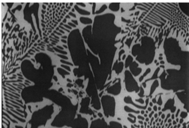
Obrázek 85: Odlišení oblasti materiálu na řezu slitiny Al-Cu v režimu zpětně odražených elektronů (BSE) Al ( Z = 13 ) – tmavší oblasti, Cu ( Z = 29 ) – světlejší oblasti (zdroj: JEOL).
