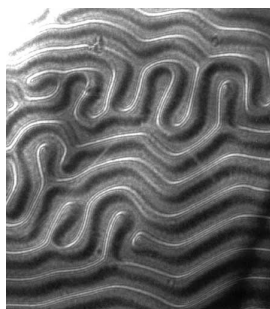
Obrázek 86: Magnetické domény v materiálu NdFeB ( http://www-hrem.msm.cam.ac.uk/gallery/pics/ndfeblarge.jpg ).
