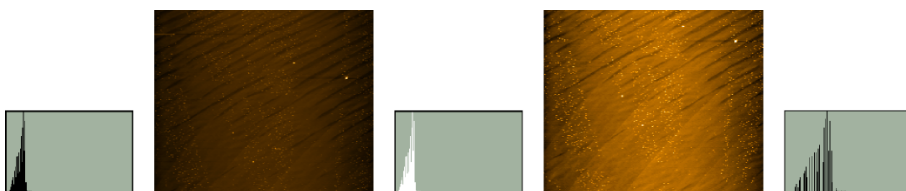
Obrázek 50: Ukázka úpravy histogramu na povrchu znečištěného skla. Zleva doprava: histogram původního obrazu, původní obraz, bíle vyznačená část histogramu, obraz po zpracování a jeho histogram.
